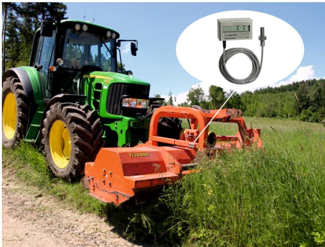
El contador de tiempo de trabajo para máquinas con toma de fuerza o piezas giratorias
