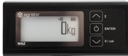
À titre d'exemple pratique, on peut citer une palette de 1 000 kg pour laquelle l'affichage indique par exemple 1 200 kg avant le calibrage. Avec le processus d'étalonnage décrit ci-dessus, la valeur indiquée peut être adaptée à la charge réelle.
