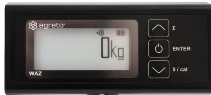
Als praktijkvoorbeeld is er een pallet van 1000 kg, waarbij de weergave voor de kalibratie bijv. 1200 kg aangeeft. Met het hierboven beschreven kalibratieproces kan de aangegeven waarde van de werkelijke belasting worden aangepast.
