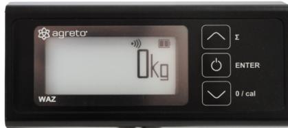
Gyakorlati példaként egy 1000 kg-os raklap ajánlott, ahol a kijelzőn a kalibrálás előtt pl. 1200 kg látható. A fent leírt kalibrációs eljárással a kijelzett érték a tényleges terheléshez igazítható.
