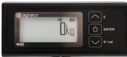
É recomendada uma paleta com 1000 kg como exemplo prático, onde o visor mostra 1200 kg antes da calibração. Com o processo de calibração descrito acima, o valor exibido pode ser adaptado à carga real.
