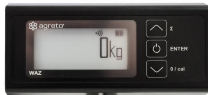
Als Praxisbeispiel bietet sich eine Palette mit 1000 kg an, bei der die Anzeige vor der Kalibrierung z.B. 1200 kg anzeigt. Mit dem oben beschriebenen Kalibriervorgang kann der angezeigte Wert der tatsächlichen Belastung angepasst werden.
