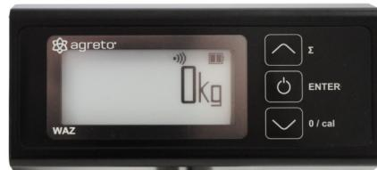
Som et praktisk eksempel kan nævnes en palle med 1000 kg, hvor indikatoren f.eks. viser 1200 kg før kalibrering. Den viste værdi af den faktiske belastning kan justeres med den ovenfor beskrevne kalibreringsproces.
