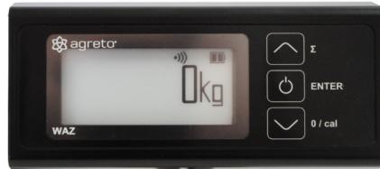
Un esempio pratico è dato da un pallet da 1000 kg laddove, prima della calibrazione, il display indichi 1200 kg. Con la procedura di calibrazione sopra descritta, il valore indicato può essere adattato al carico effettivo.
